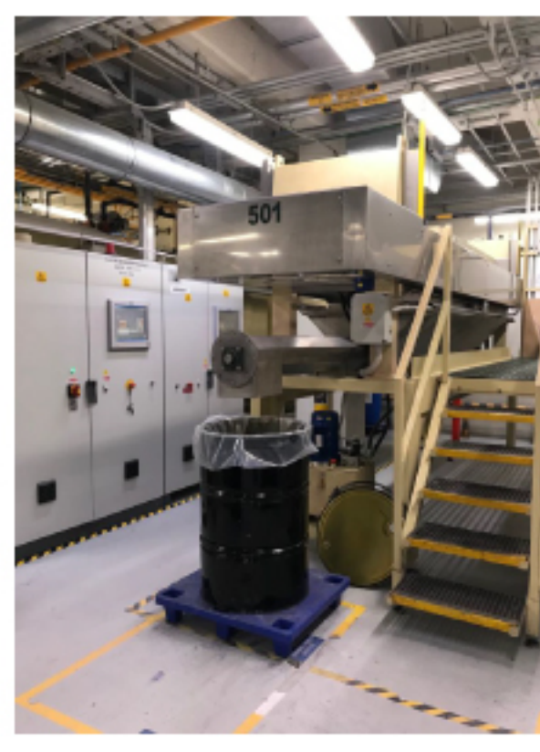
Imagen 2. Proceso planta de tratamiento de procesos productivo AQUA-SAVE. Trata el agua y recirculación de la solución de limpieza para los procesos calcográficos.
