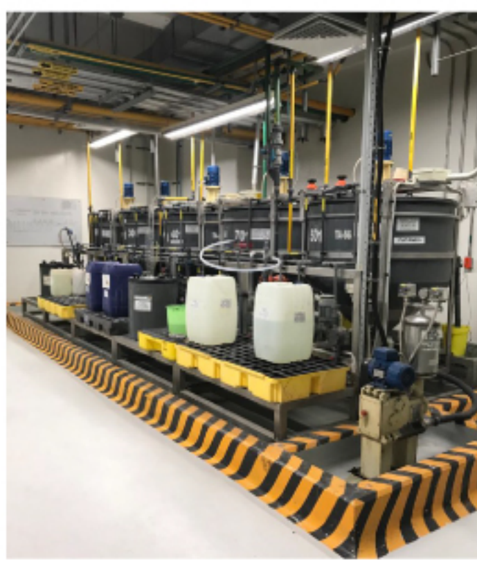
Imagen 1. Proceso planta de tratamiento de productivo SEPOTRATT. Trata el agua con metales pesados provenientes del proceso de pre-prensa.
