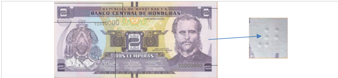
Ilustración 7. Se muestra el billete de 2 lempiras hondureñas, cuya aplicación del braille no sigue el requerimiento de distancia entre puntos, pues las distancias son menores a las requeridas por el sistema.
